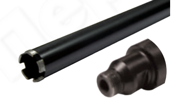
k411 Алм. коронка Ø56, Н=300 мм, резьба наружная, болт 1/2", для сверл. отверст. под стойку 40x40 мм
