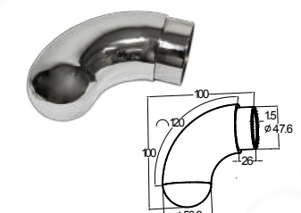
k020 304 P X Отвод оконечный трубы Ø50.8x1.5мм, с круглой заглушкой, литой
