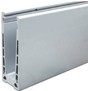
k601-5 Профиль алюминиевый зажимной 118х45 мм для несущего стекла 10-16 мм, анодированный, матовый, длина 6 метров, облегченный
