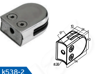
k538-2 Стеклодержатель штампованный под стекло 10мм, под стойку Ø38 мм, 40x22x53 стекло 8мм
