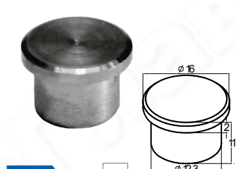
k012 304 P X k012-2 316 P X Заглушка точеная под Ø16 x 1.5 мм, высота 11мм.
