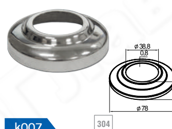
k007 k007-3 Низ стойки Ø38.1 мм, S=0.8 мм, внешний Ø78x12 мм, фигурный
