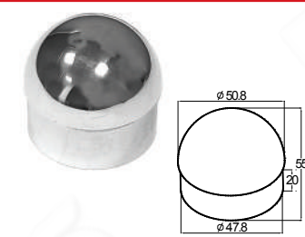
k092 304 P X Заглушка литая сферическая для трубы Ø50.8x1.5 мм
