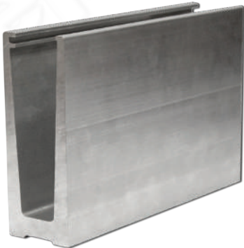
k601-3 Профиль алюминиевый зажимной 118х45 мм для несущего стекла 10-16 мм, не анодированный, длина 6 метров
