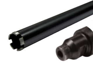
Ф-0688 Алмазная коронка Ø42, Н=300 мм, резьба наружная, болт 1/2"
