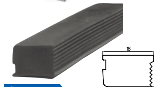
k601-08 Лицевая уплотнительная резинка 16x12 мм для стекла 15 мм или триплекса 8+8 мм
