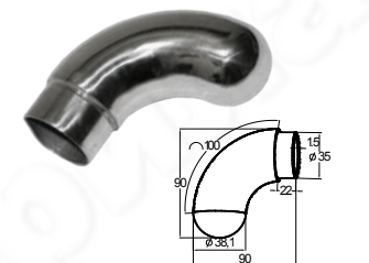
k384 304 P X Отвод оконечный поручня Ø38.1x1.5мм, с круглой заглушкой, литой
