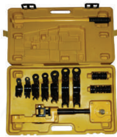
k914 Трубогиб ручной в пластиковом кейсе с роликами для трубы, 10, 12, 14, 16, 19, 22 и 25 мм. 660x460x180 мм. 25 кг. R гнутья: 10-25 мм
