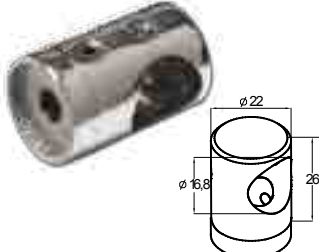
k065 Ригеледержатель на стойку под плоскость с отв. 16,8 мм, для ригеля 16мм, литой, внеш Ø22, высота 30 мм
