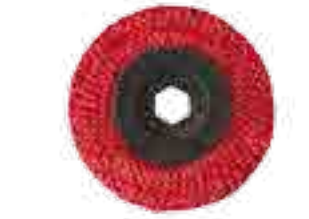
k422 УШМ-полировка, красная веревка, Ш100x7 мм, с углублением для шайбы (используется с белой пастой) для быстрой полировки на больших оборотах
