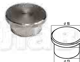
k040 Заглушка точеная под трубу Ø16 x 1.5 мм, высота 7 мм. AISI 304
