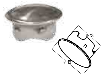
k200 Заглушка забивная штампованная под Ø16 x 1.5 мм, толщина 0.5мм
