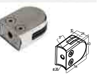
k538-10 Стеклодержатель штампованный под стекло 10мм, под стойку Ø38 мм, 40x22x53
