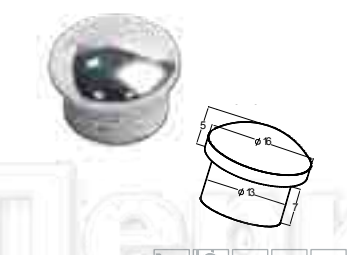
k264 Заглушка точеная сферическая полированная под Ø16 x 1.5 мм, высота 7 мм. AISI 304
