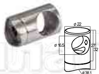
k018-5 Ригеледержатель на трубу Ø38,1 x 16,5 мм, с потаем под вытяжную резьбовую заклепку
