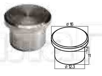
k012-2 Заглушка точеная под Ø16 x 1.5 мм, высота 11мм. AISI 316
