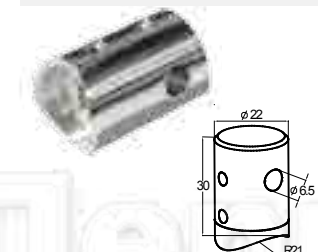
k267 Держатель тросика Ø6 мм, 22x30 мм, под Ø42.4 мм
