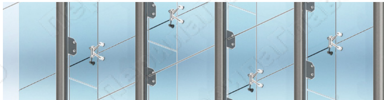
k290-X PSS AISI 304 k291-X PSS AISI 316 X-спайдер для установки на стеклянное ребро Предельные эксплуатационные нагрузки Fx -2500 Н (250кг), Fy -1500 Н (150кг)
