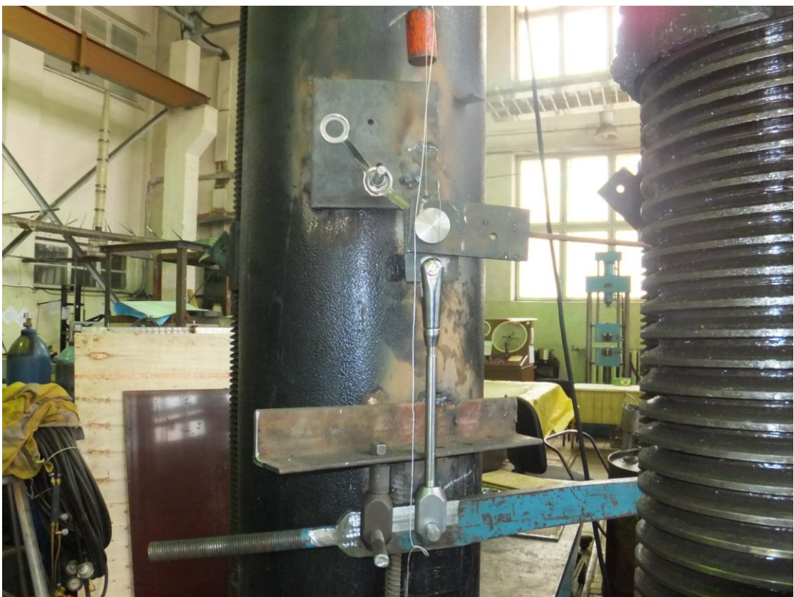
Рисунок 12 – Испытание спайдера I на растяжение
