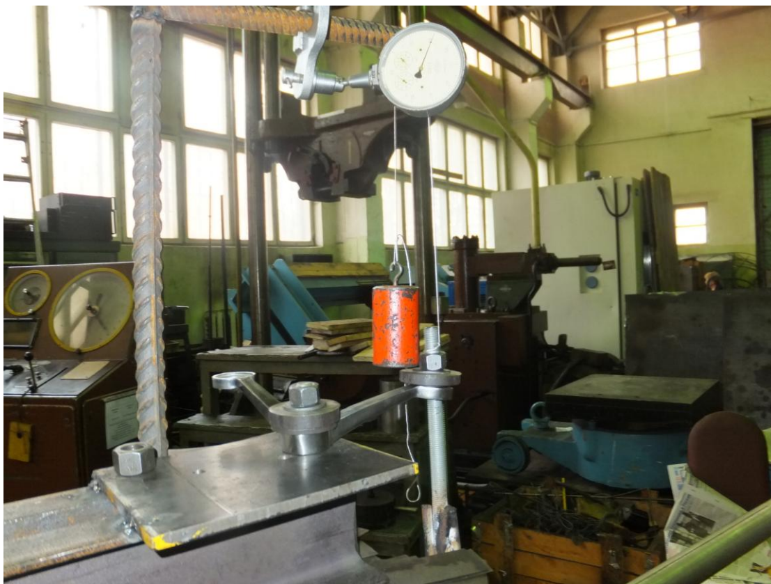
Рисунок 15 – Испытание спайдера V на изгиб
