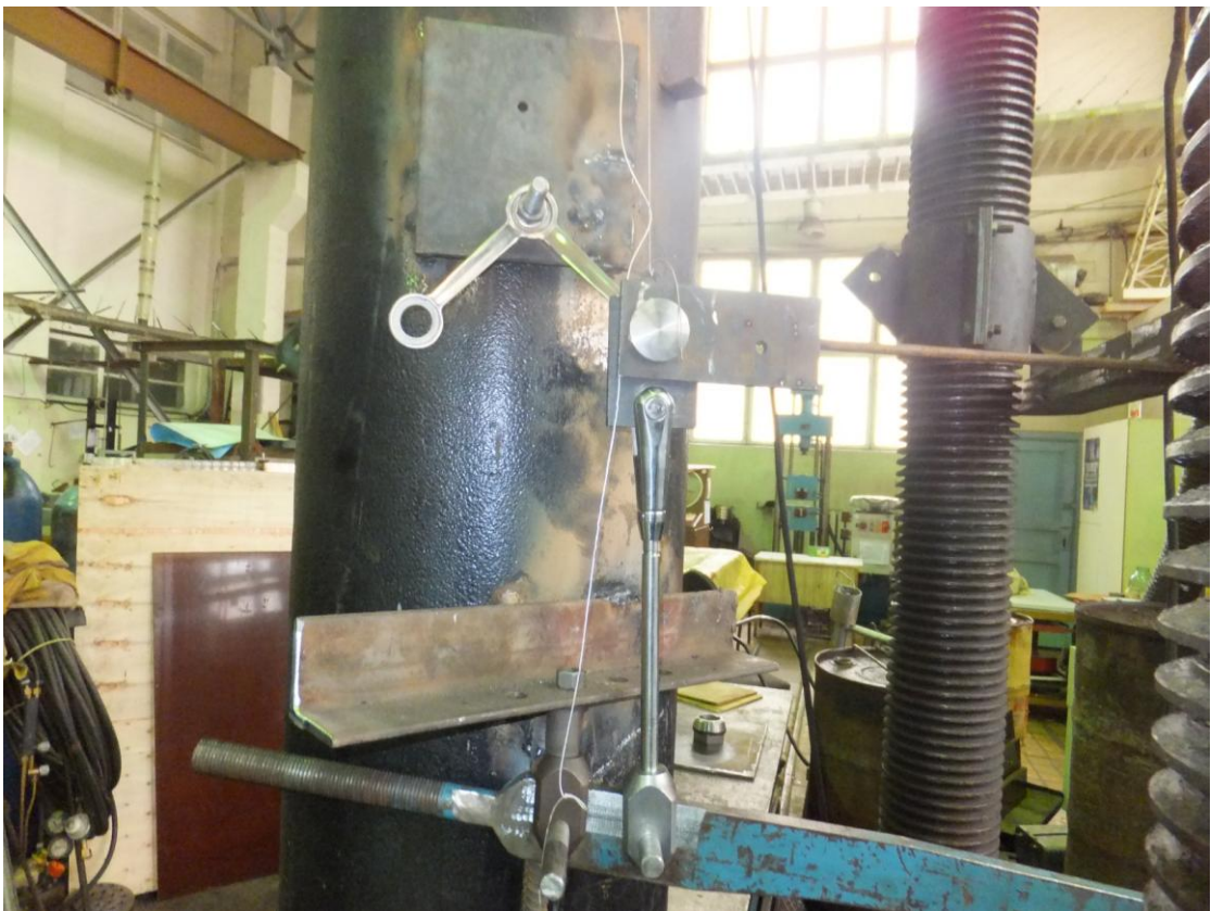
Рисунок 11 – Испытание спайдера V на растяжение
