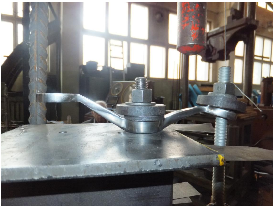
Рисунок 18 – Испытание спайдера I/2 на изгиб
