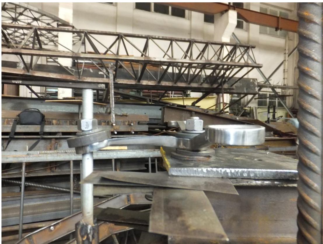
Рисунок 16 – Испытание спайдера Y на изгиб
