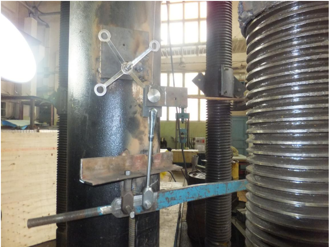
Рисунок 9 – Испытание спайдера X на растяжение
