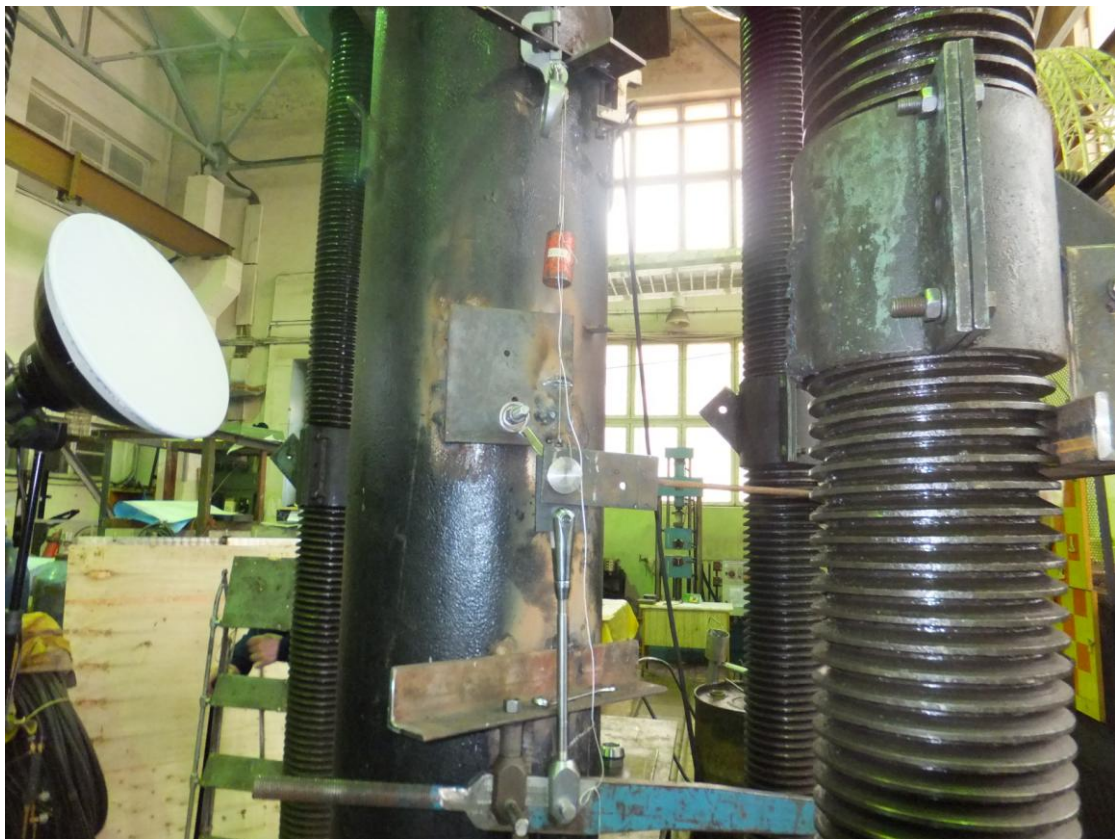
Рисунок 13 – Испытание спайдера I/2 на растяжение
