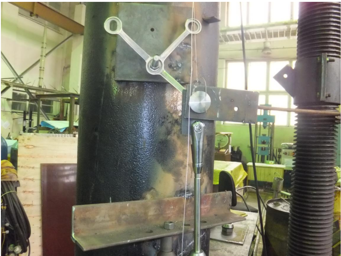
Рисунок 10 – Испытание спайдера Y на растяжение
