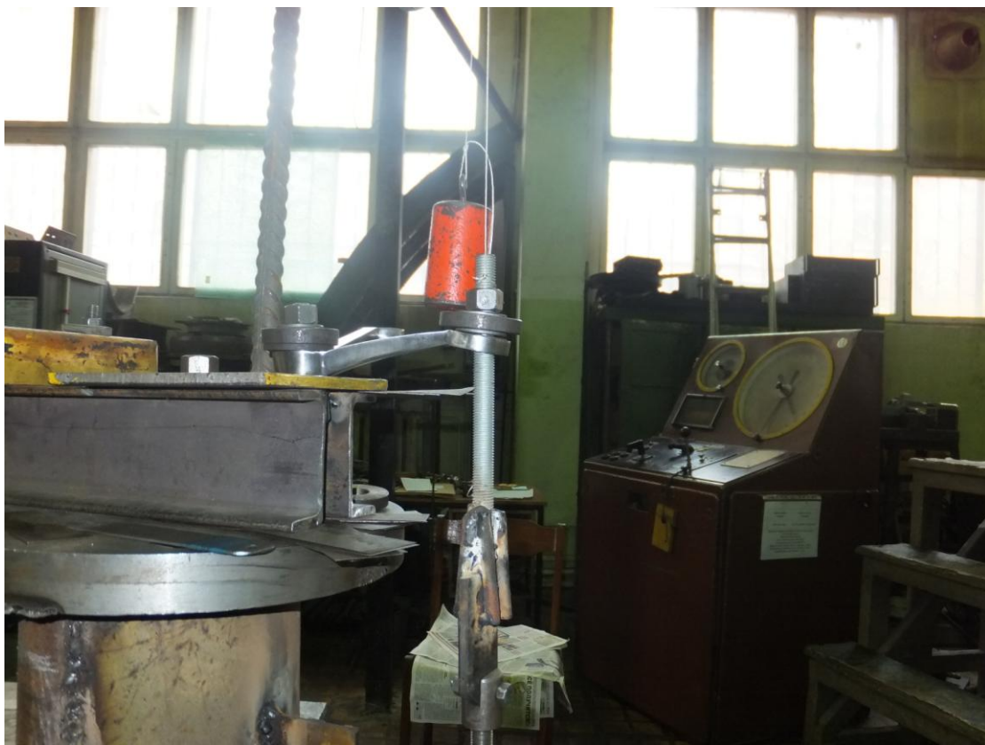
Рисунок 17 – Испытание спайдера Y/2 на изгиб
